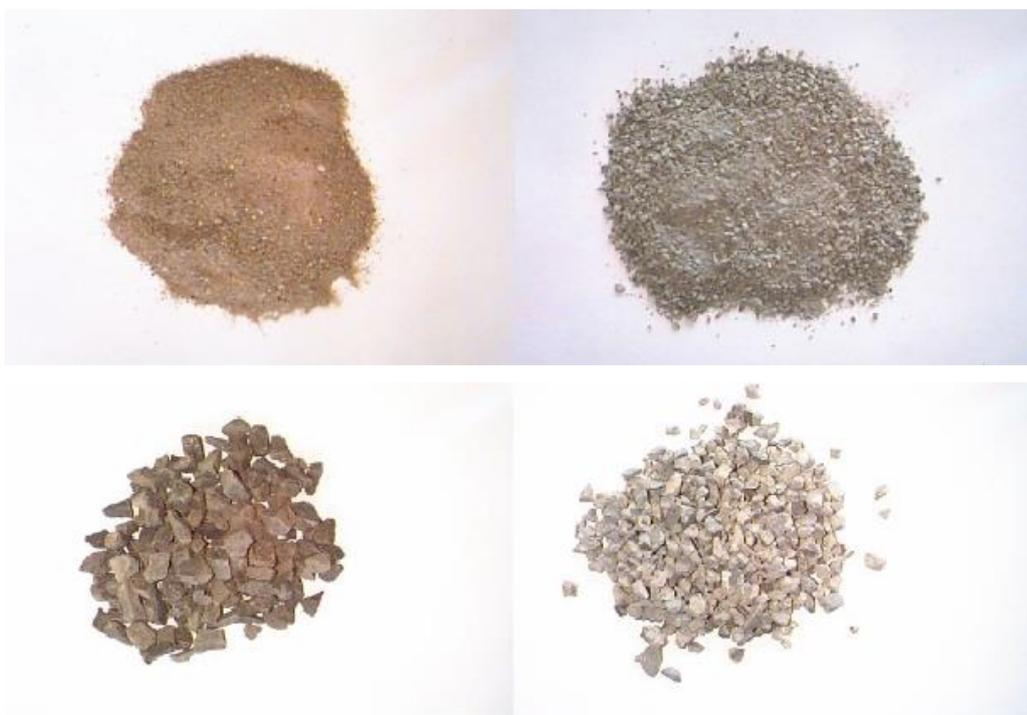
Figura 03: Agregados naturais e reciclados (Esquerda e direita respectivamente)
