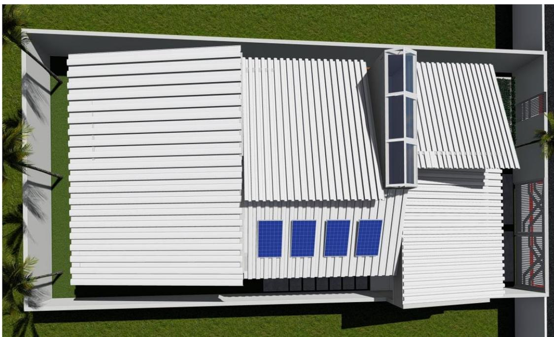
Foto 12: 3D Cobertura com claraboia e painéis solares – Planta 02
