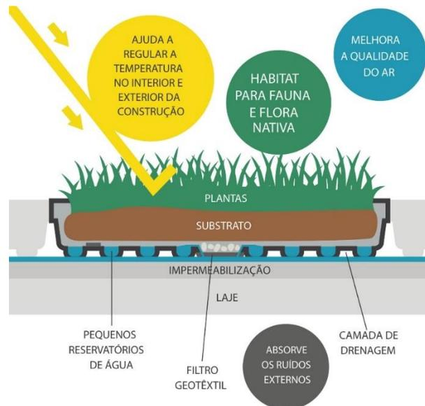
Figura 18: Esquema do telhado verde
