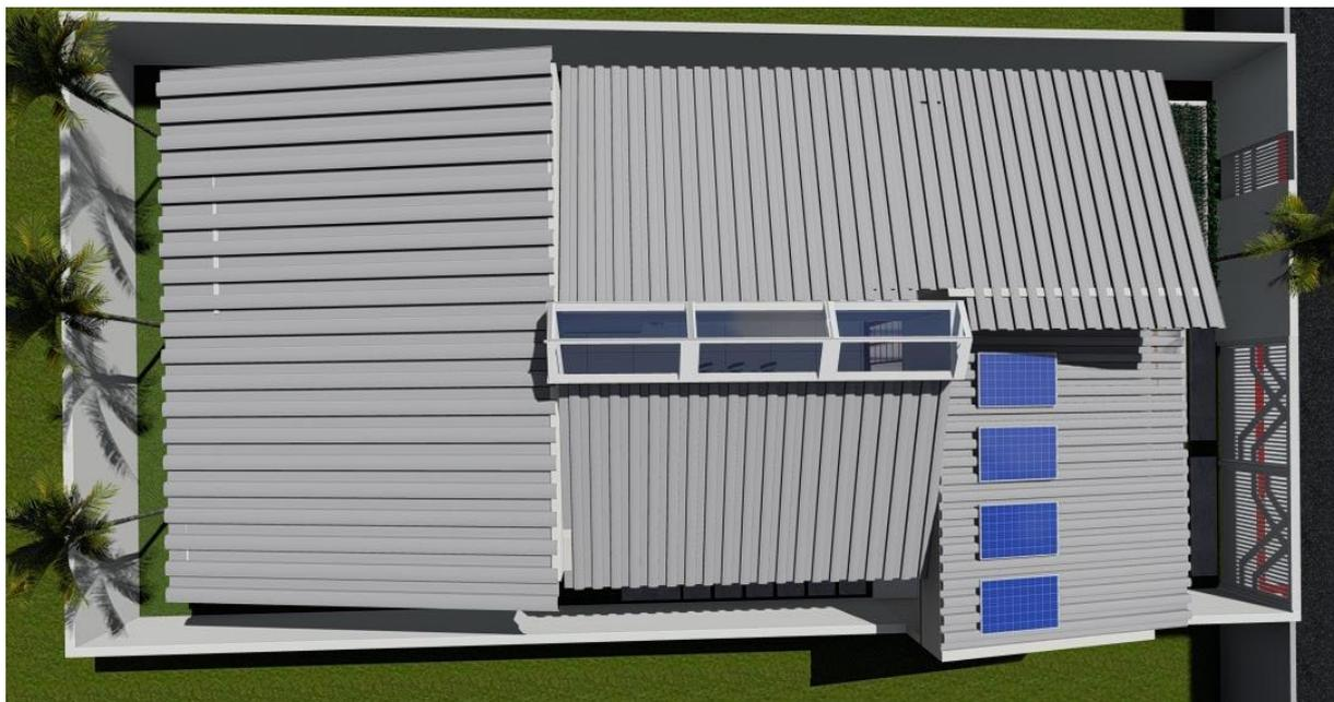
Foto 16: 3D Cobertura com claraboia, painel veneziano e painéis solares– Planta 03
