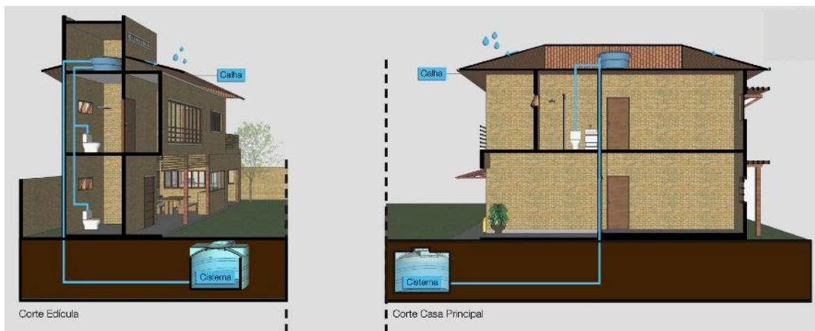
Figura 07: Esquema do uso de cisternas.
