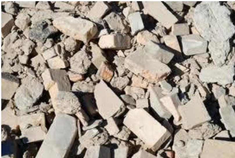
Figura 02: Resíduos de demolição e construção (RDC)
