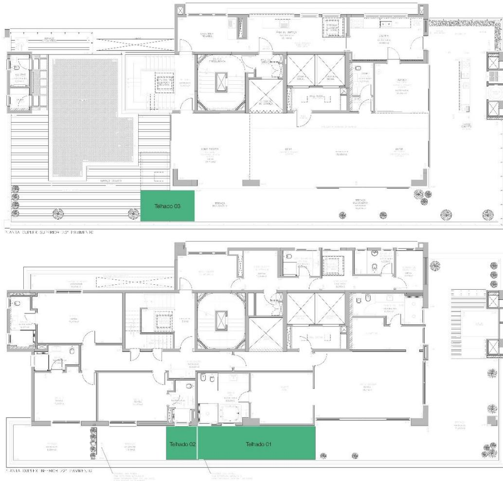
Figura 32: Indicação de telhado verde
